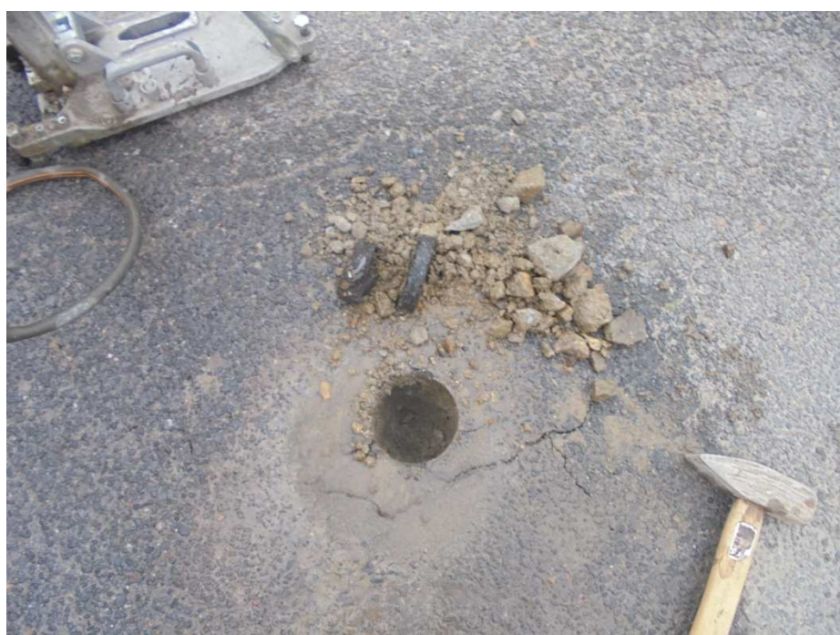
Wykonywanie odwiertów 2+4cm bitum, 10cm tłuczeń, kruszywo granitowe, 7cm stabilizacja z kamieniami, nasyp budowlany
