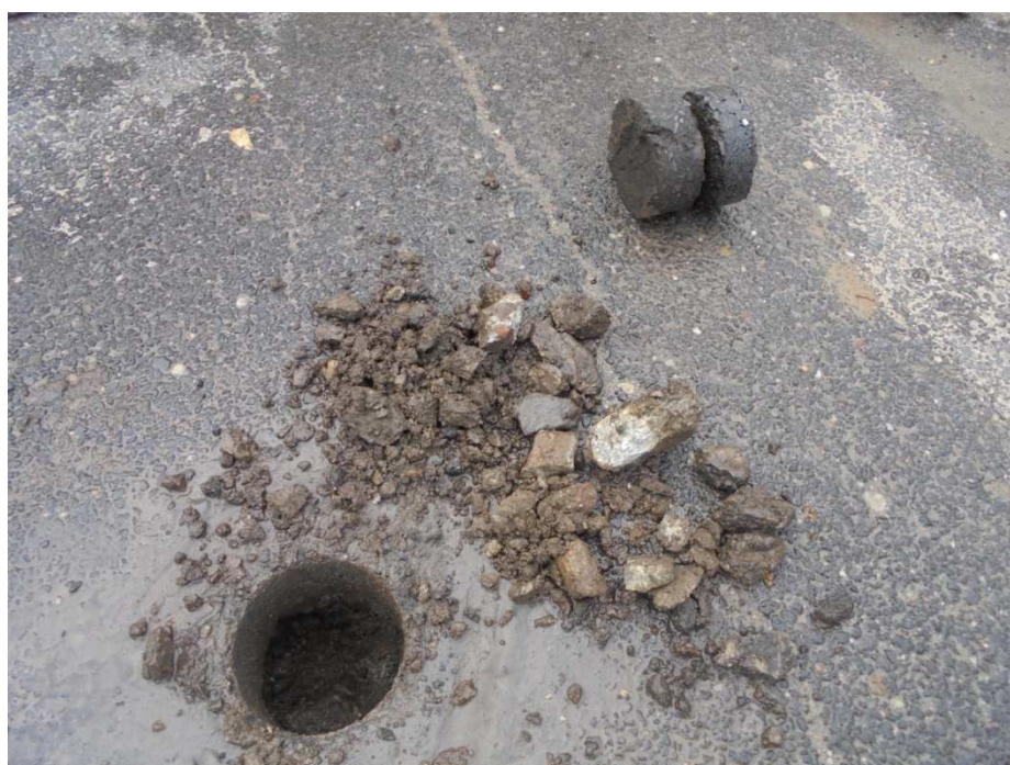
Wykonywanie odwiertów 3,5+5cm bitum, 14cm tłuczeń/kruszywo/ kawałki kostki granitowej, piasek
